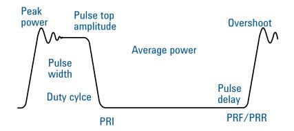
Figure 6. Pulse parameters
