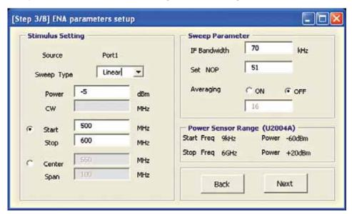
Figure 9. ENA parameter setup
