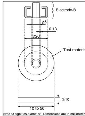
**Fig. 8 Electrode B Dimensions**
