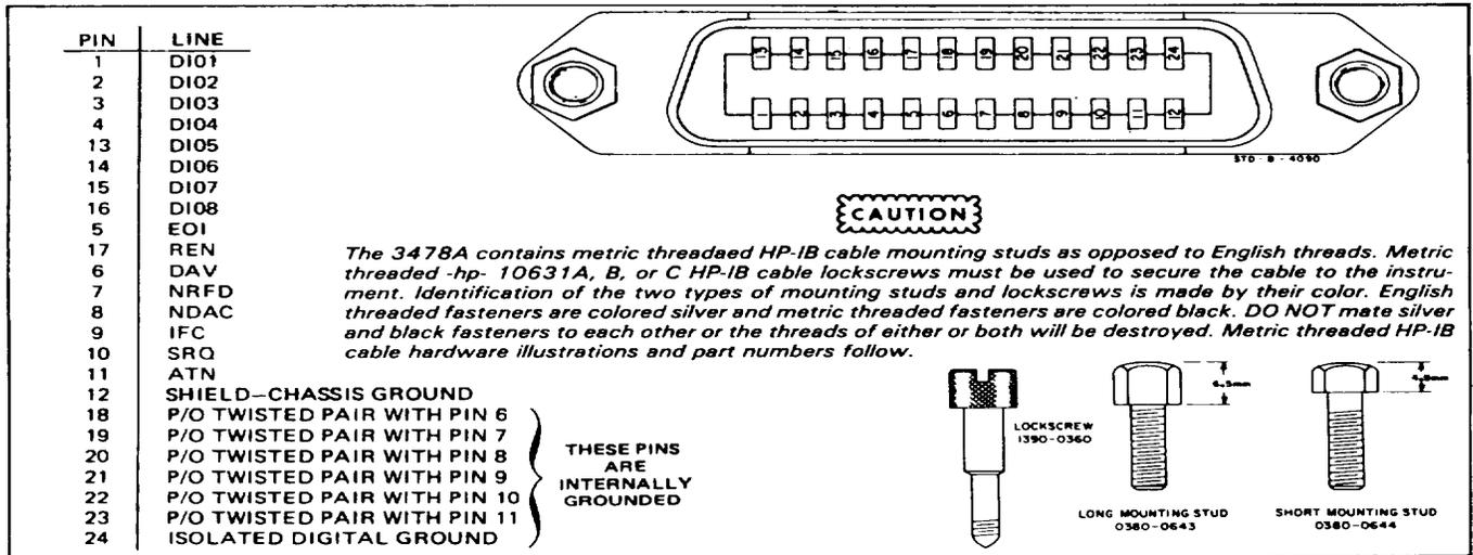
Figure 2-5. HP-IB Connector
