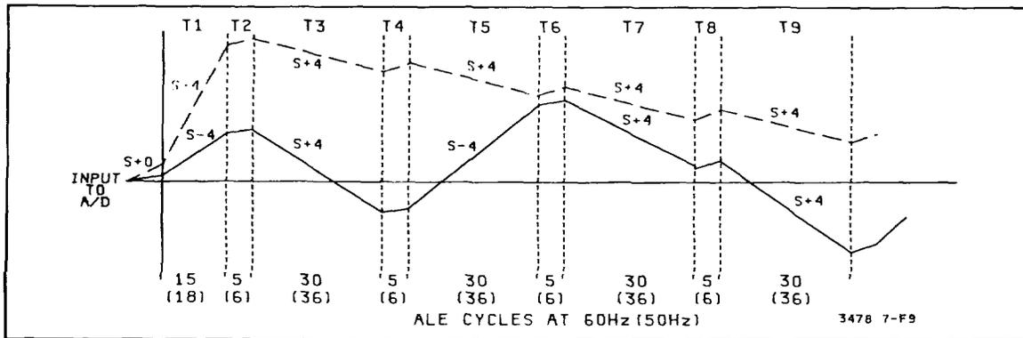
Figure 7-F-9. Runup Slopes (4 1/2 Digit Model)
