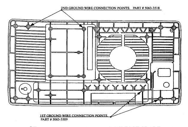
PT BACK BEZEL GROUNDING WIRES UPGRADE
