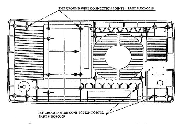
PT BACK BEZEL GROUNDING WIRES UPGRADE
