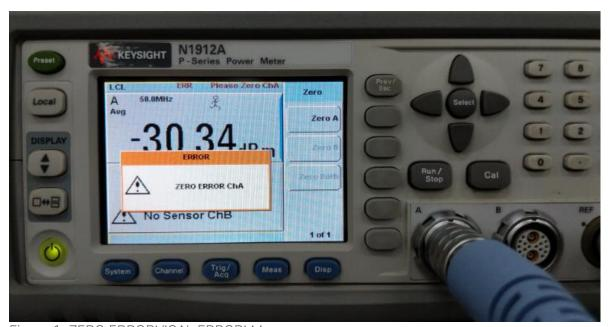
Figure 1: ZERO ERROR'/'CAL ERROR' Message
